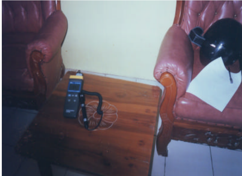
Gambar Pengukuran Kelembaban Relatif di Dalam Ruang
