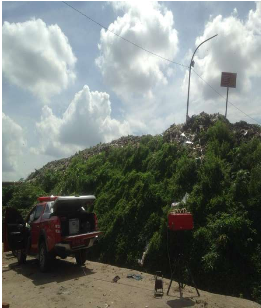
Pemasangan Alat Air Sampler Impinger Model CS 5-96 AC
