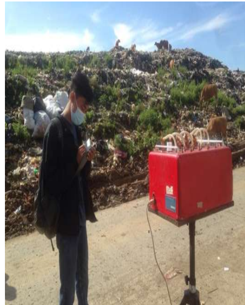
Pengambilan sampel H_2S pada Udara Ambien
