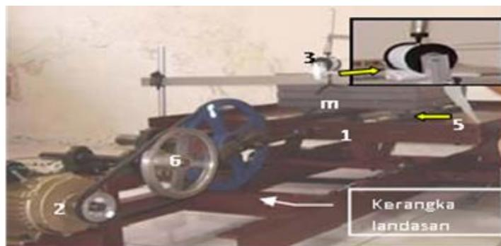
**Gambar 2.4 :** Foto fisik alat uji gempa bumi dengan mekanisme engkol.
