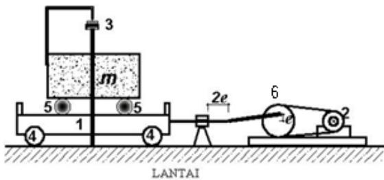
**Gambar 2.3 :** Pemodelan fisik alat uji gempa bumi dengan mekanisme engkol.
