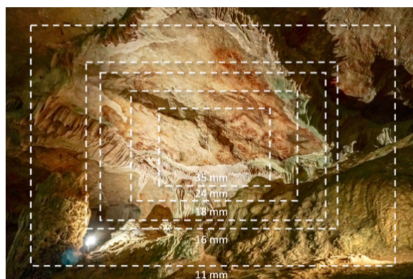
Gambar 5. Ilustrasi perbandingan cakupan area pada tiap fokal lensa
