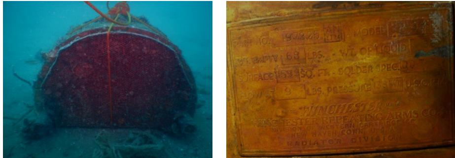
Gambar 26. Radiator pada bangkai pesawat Lockheed P-38 Lightning
