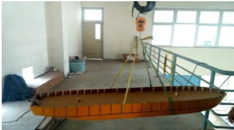
Gambar 4.1.1. Proses Penimbangan Model Kapal
