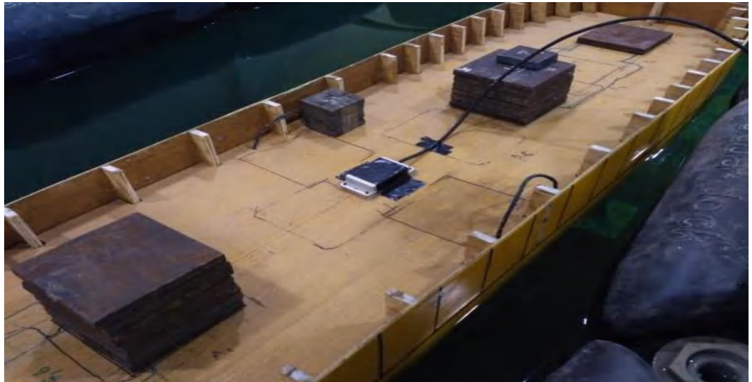
Gambar 4.1.4. Proses Inclining Test pada model
