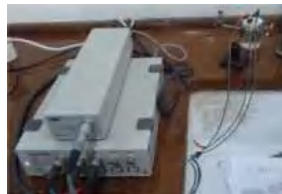
Proses pengukuran kapasitansi spesifik menggunakan alat Potensiostat.
