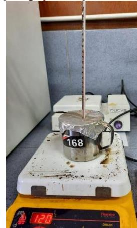
Gambar 12. Proses ekstraksi untuk pengujian *reprodusibilitas* analis 2
