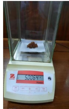
Gambar 8. Penimbangan sampel untuk pengujian *reprodusibilitas* analis 1
