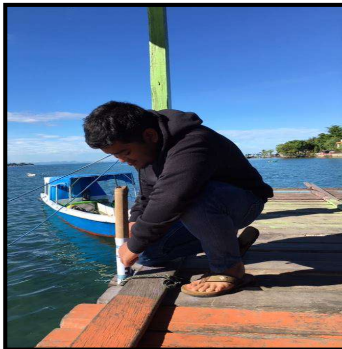
Gambar 23. Pemasangan Tongkat Pasut
