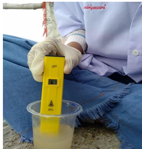
Gambar 3. Pengukuran pH Air Limbah Domestik
