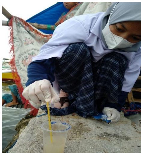
Gambar 2. Pengukuran Suhu Air Limbah Domestik
