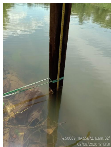
(c) Pengukuran tinggi muka air.
