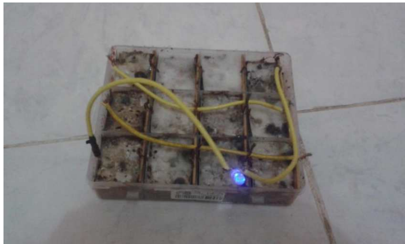
Lampiran 4 Sel Volta elektrolit kulit pisang raja
