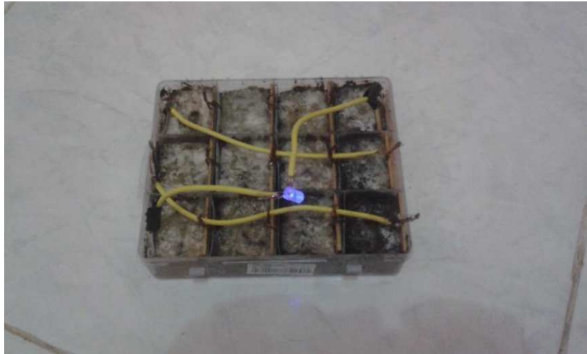
Lampiran 6 Sel Volta elektrolit kulit pisang tumbuk
