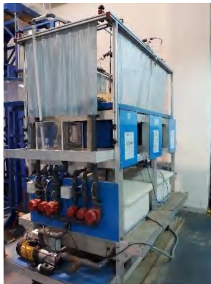
Gambar 2.6 Alat Rainfall Simulator (Laboratorium Hidrolika Fakultas , Teknik Jurusan Sipil Universitas Hasanuddin2019)
