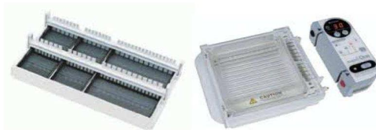
Gambar 2-24. Alat elektroforesis
