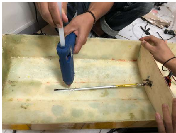
Gambar 3.13 Pemasangan shaft dan mesin pada model.
