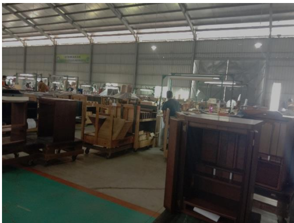
Proses Assembling : Komponen-komponen akan dirakit menjadi 1 set butsudan
