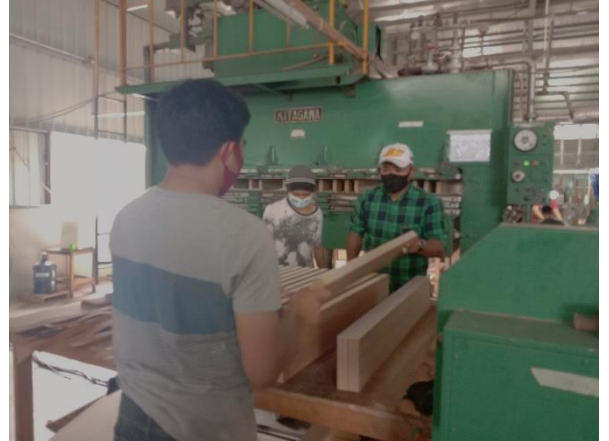
Proses Laminating dengan Menggunakan Mesin Hot Press
