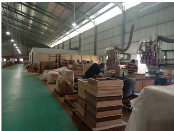
Proses Pembuatan Alur dengan Menggunakan Mesin NC Router
