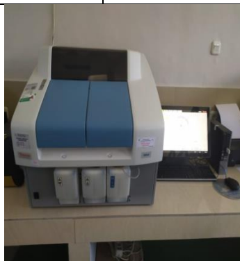
Proses pengujian dengan alat Thermo Scientific Indiko Automatic Analyzer
