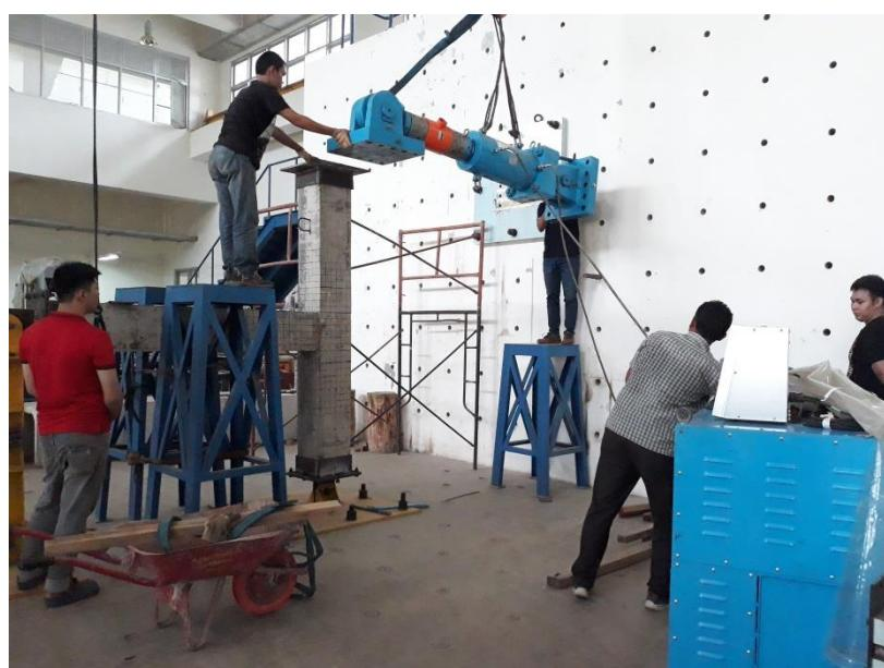
Gambar 14. Pemasangan alat uji actuator ke benda uji
