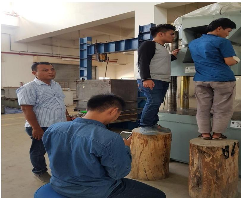
Gambar 6. Pengujian tarik besi tulangan ( $\varnothing 8$ , D13, D16)
