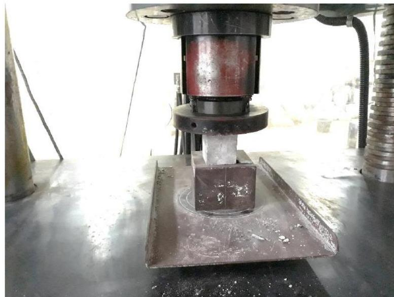
Gambar 8. Pengujian Kuat Tekan Mortar
