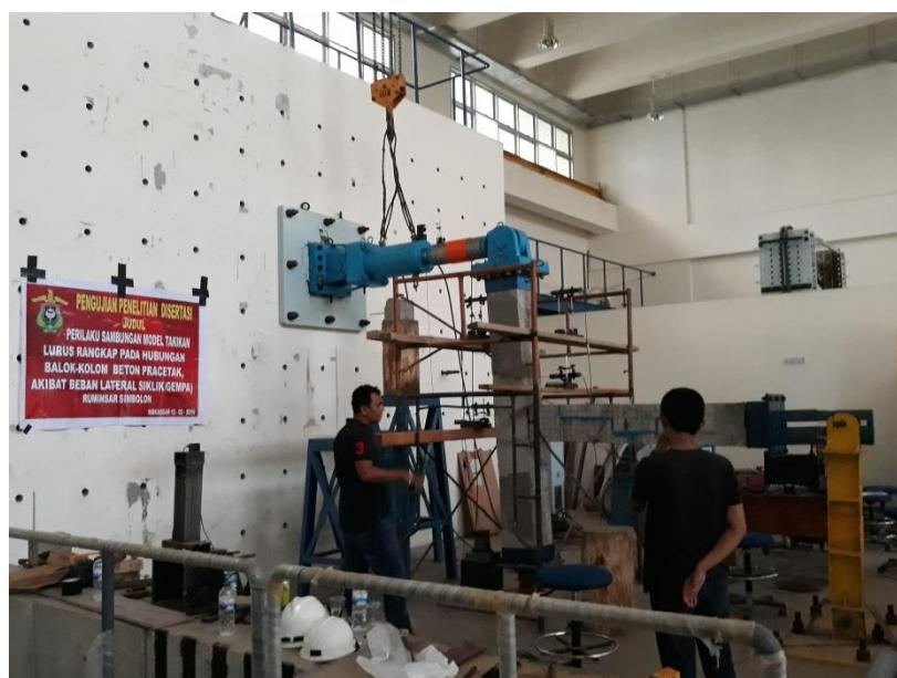
Gambar 18. Pengujian Benda Uji Balok Kolom STR-1
