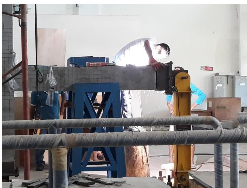
Gambar 16. Pemasangan perletakan roll
