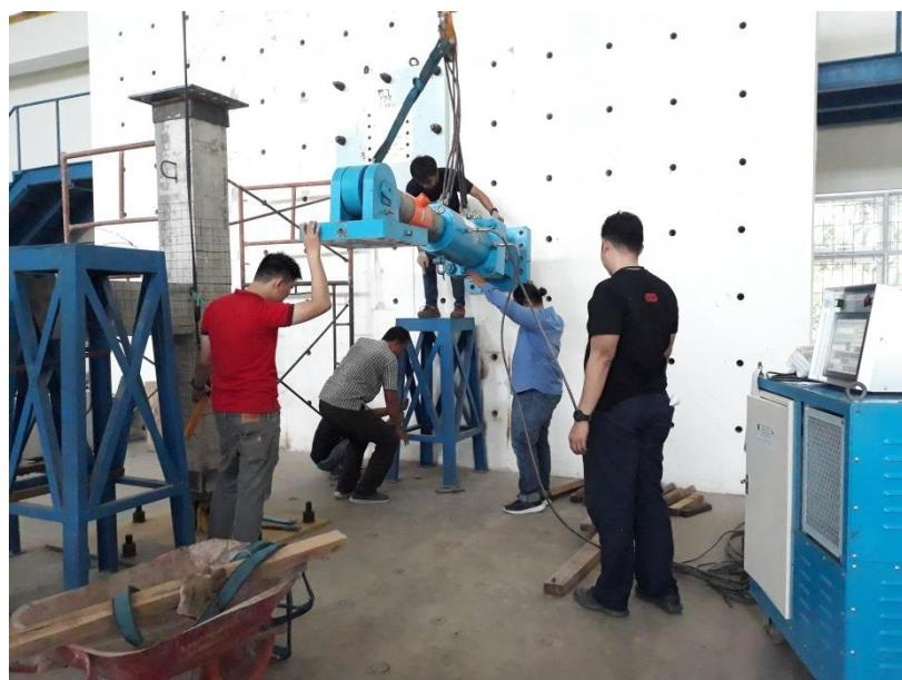
Gambar 13. Pemasangan alat uji attenuator ke dinding
