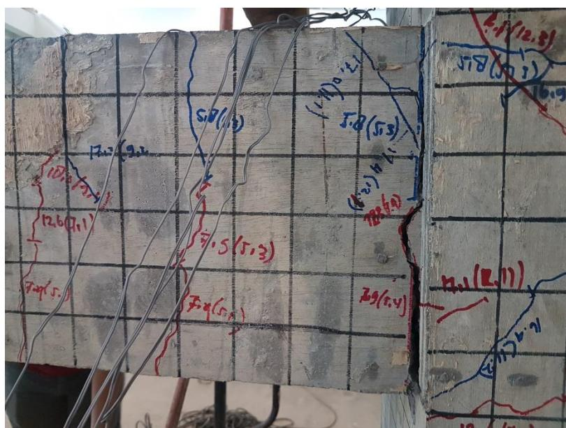
Gambar 22. Pola retak di pertemuan Balok Kolom STR-1
