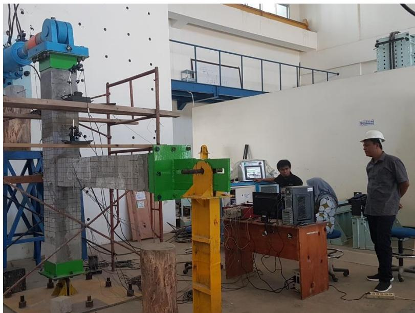
Gambar 19. Pengujian Benda Uji Balok Kolom STR-2
