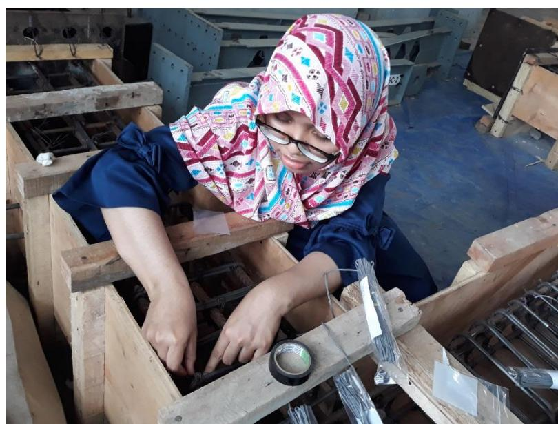
Gambar 12. Pemasangan Strain Gauge
