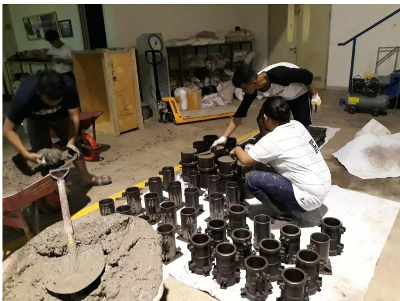
Gambar 3. Pembuatan Silinder
