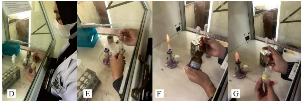
(D= Proses Pengambilan Reagent Nesller, E= Proses Memasukkan Reagent Nessler pada Tabung Reaksi, F= Proses Pengambilan Reagent Naphtalamine, G= Proses Pengambilan Reagent Sulfanilic Acid)
