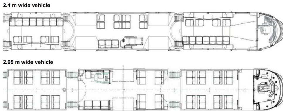
Gambar 2.4 Trem dengan lebar 2,4 m dan 2,65 m
