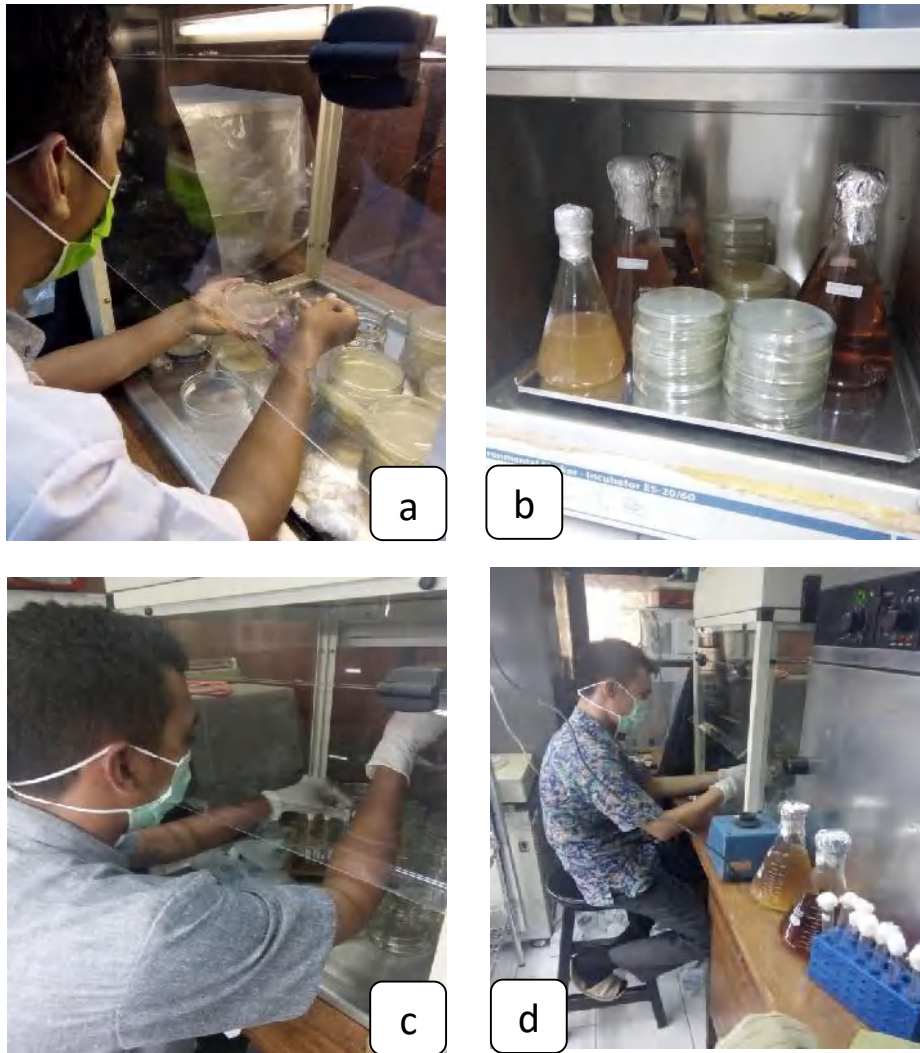
Gambar Lampiran 5. Isolasi dan inokulasi mikroba penambat nitrogen dan mikroba pelarut fosfat: (a) Mengisolasi mikroba penambat nitrogen dan mikroba pelarut fosfat pada medium; (b) Menginkubasi mikroba penambat nitrogen dan mikroba pelarut fosfat dan dishaker dengan kecepatan 130 rpm selama 7 hari; (c) Pengenceran kepadatan bakteri sebanyak 100 mL; dan (d) menghitung kepadatan mikroba penambat nitrogen dan mikroba pelarut fosfat.
