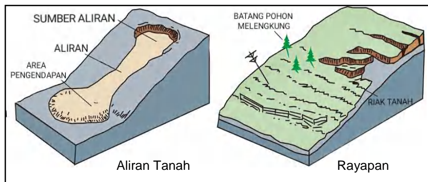
Gambar. 10 Tipe aliran dan rayapan (sumber ; Tipe dan Proses Longsor, Highland and Johnson, 2004)
