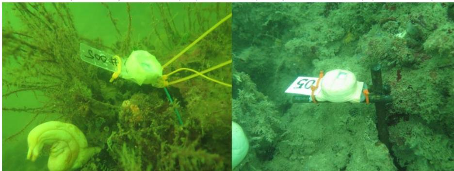
**Gambar 4.** Data logger HOBO yang dipasang di area peletakan ARMS.
