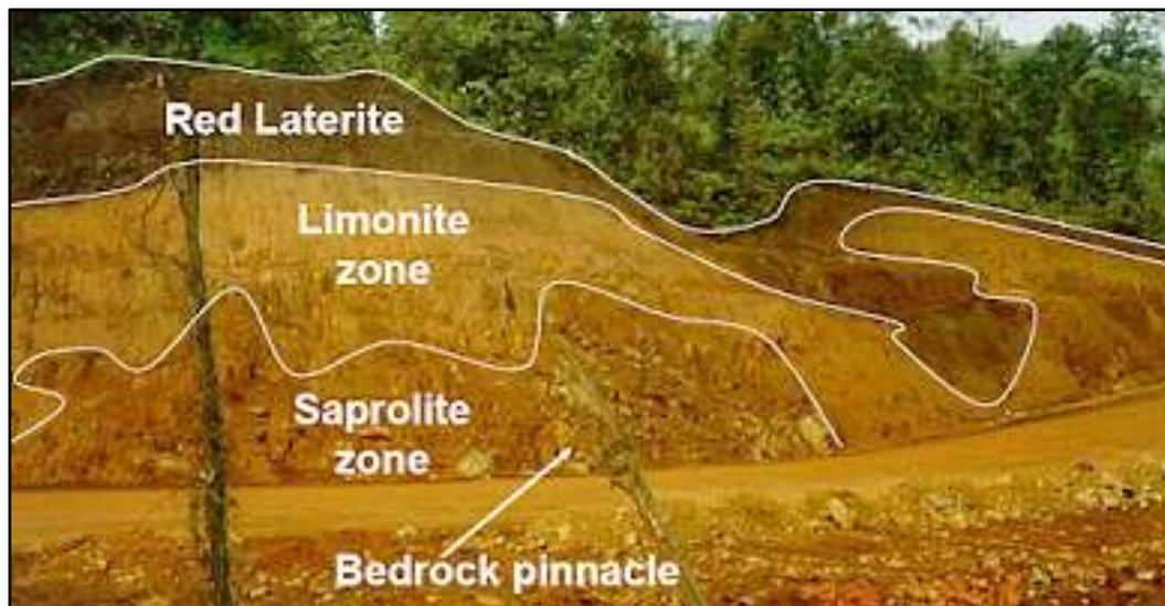
Gambar 1 Kenampakan lapisan endapan nikel laterit
