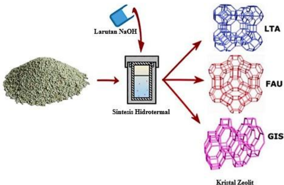
Gambar 1.2. Rangkuman grafis dari pembentukan fase zeolit secara hidrotermal (Dimodifikasi dari Blicharz, et al., 2022)
