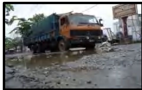
Gambar 4. Kendaraan overdimensi yang menyebabkan overloading
