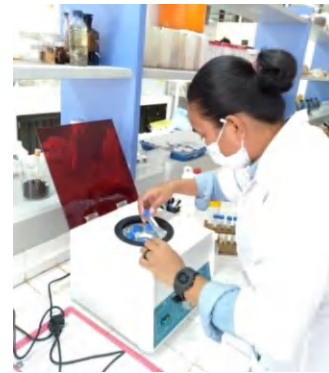
Melakukan sentrifus pada vial yang berisi spons
