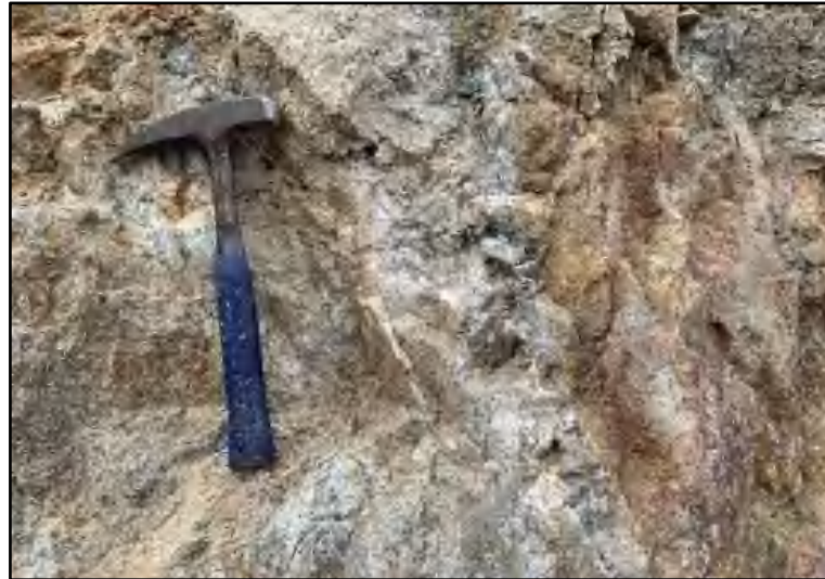
Gambar 8. Pelapukan kimia yang menunjukkan perubahan warna pada litologi monzonit akibat proses oksidasi pada stasiun 5 difoto relatif arah N 120°E
