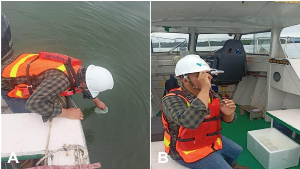
Kegiatan saat sampling (A) Pengambilan sampel air, (B) Pengukuran salinitas menggunakan Handrefraktometer .
