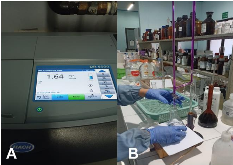
Kegiatan di Laboratorium (A) Pengukuran menggunakan Spektrofotometer, (B) Pengukuran BOT.
