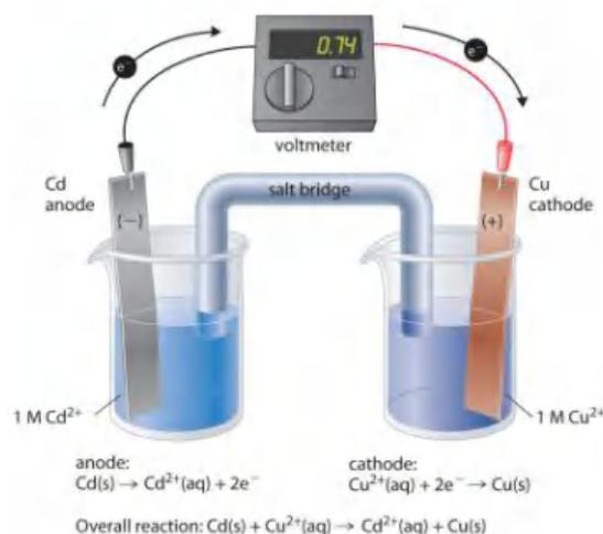
Gambar 8 Rangkaian sel Volta dan reaksinya
