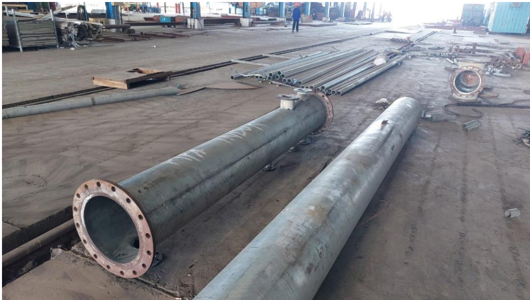
Lampiran 17 Proses fabrikasi pipa induk
