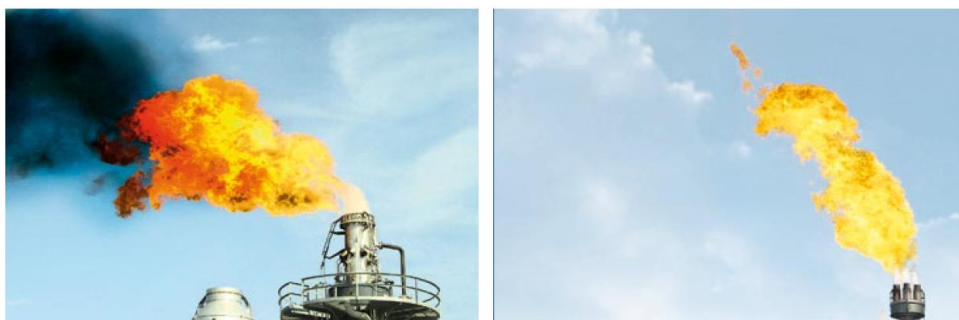
Gambar 2. 15 Pemanfaatan Injeksi Uap pada Flare Pembuangan Gas. Efektivitas uap dalam menekan asap: (kiri) tanpa uap, (kanan) dengan uap (Callidus Technologies, 2019)
