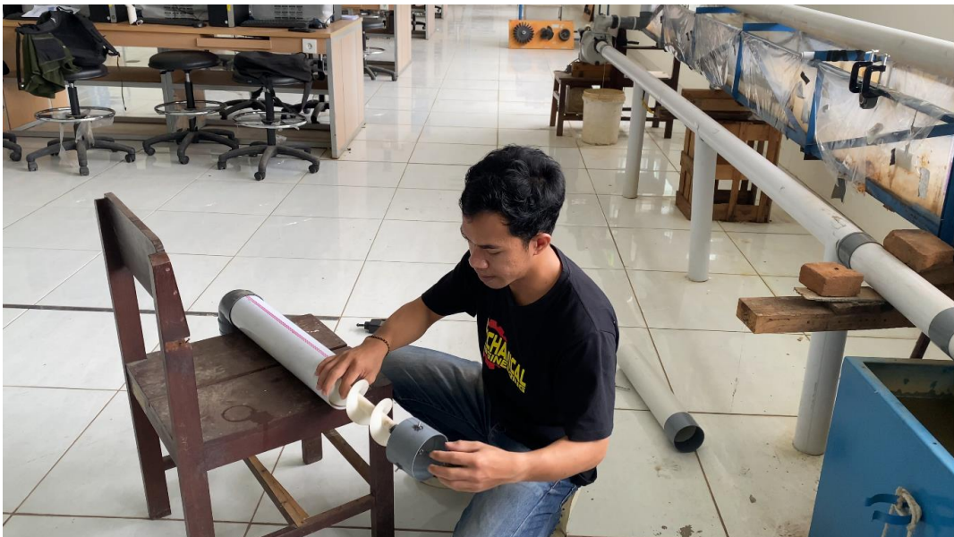
gambar pemasangan turbin ke dalam pipa 3 inch
