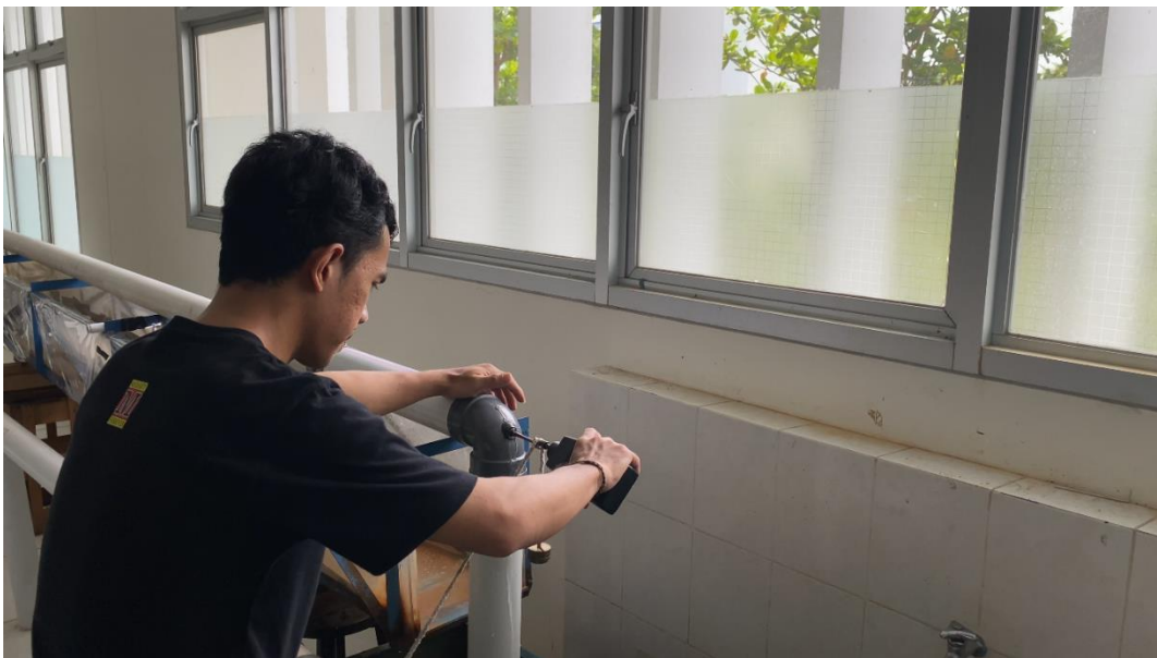
gambar pengukuran kecepatan putaran turbin menggunakan tacometer
