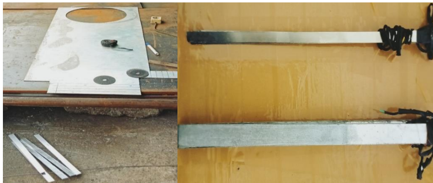
Material elektrode (komersil), Nikel (atas) dan Aluminium (bawah)
