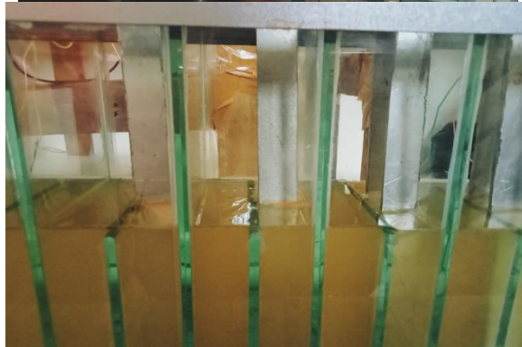
Proses pengolahan dengan elektrode berbahan aluminium
