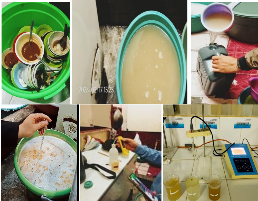
Proses pengambilan sampel air limbah rumah makan lokal di Kota Makassar, serta uji suhu, pH dan konduktivitasnya
