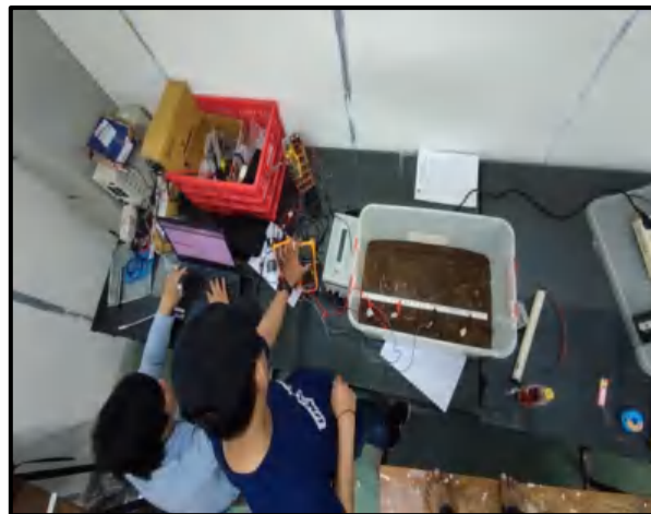
Pengukuran Menggunakan Konfigurasi Komposit Gradien dan dipole-dipole
