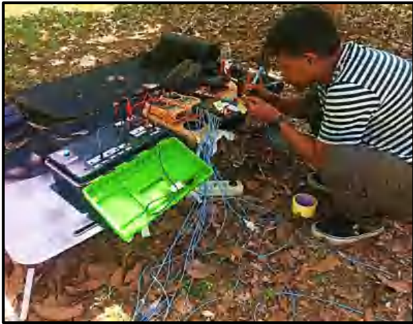
Pembuatan Label Nama Pada Kabel Elektroda
