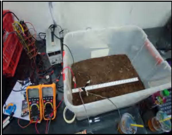
Pengukuran Menggunakan Konfigurasi Wenner
