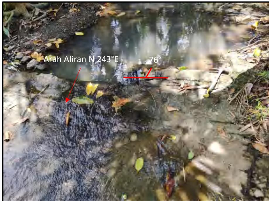
Gambar 27 Kenampakan arah aliran sungai terhadap litologi tufa yang memperlihatkan tipe genetik obsekuen berkedudukan  $N 325^{\circ}E/76^{\circ}$ , dengan arah aliran  $N 243^{\circ}E$ , arah foto  $N 27^{\circ}E$  pada stasiun 56 di anak Salo Mico, Kecamatan Salomekko
