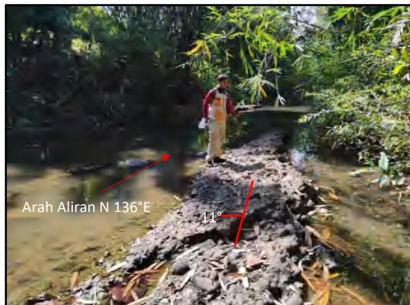
26 Kenampakan arah aliran sungai terhadap litologi aglomerat yang memperlihatkan tipe genetik subsekuen berkedudukan N 305°E/11°, dengan arah aliran sungai N 136°E, arah foto N 118°E pada stasiun 82 daerah Gattareng, Kecamatan Salomekko
