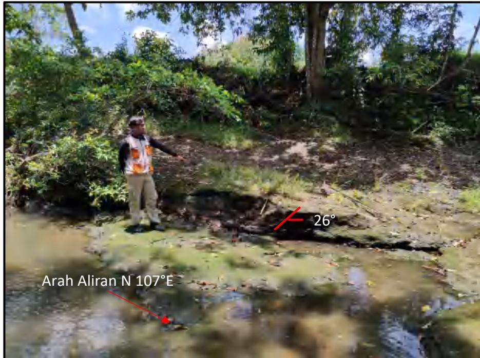
Gambar 28 Kenampakan arah aliran sungai terhadap litologi tufa yang memperlihatkan tipe genetik konsekuen berkedudukan  $N 343^{\circ}E/26^{\circ}$ , dengan arah aliran  $N 107^{\circ}E$ , arah foto  $N 347^{\circ}E$  pada stasiun 58 di anak Salo Mico, Kecamatan Salomekko
