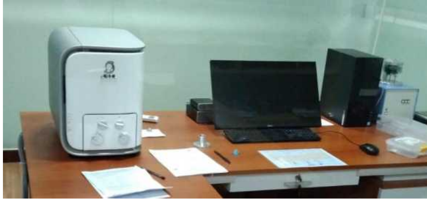
Gambar 31 Mikroskop JEOL JCM 6000 plus (SEM,EDS)
