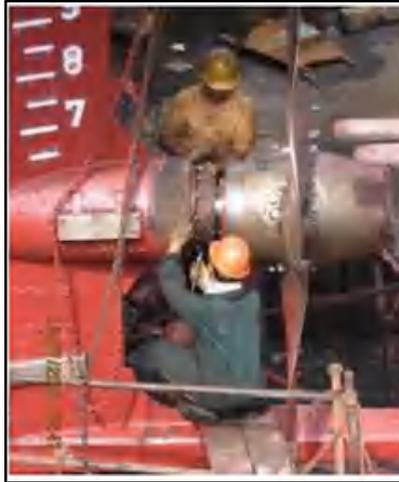
Gambar 2.11 Pemasangan Propeller
