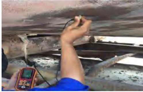
**Gambar 3. Pengecekan ketebalan plat**
