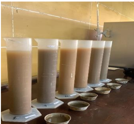
Lampiran Gambar 5. Pengukuran C-organik dengan metode Walkey and Black di Laboratorium Kimia dan Kesuburan Tanah Fakultas Pertanian Universitas Hasanuddin
