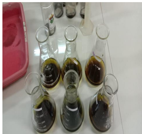
Lampiran Gambar 5. Pengukuran C-organik dengan metode Walkey and Black di Laboratorium Kimia dan Kesuburan Tanah Fakultas Pertanian Universitas Hasanuddin
