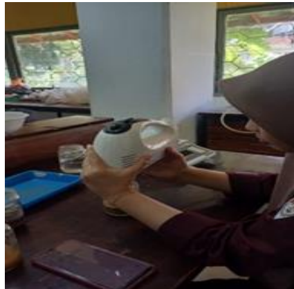
Lampiran Gambar 5. Pengukuran C-organik dengan metode Walkey and Black di Laboratorium Kimia dan Kesuburan Tanah Fakultas Pertanian Universitas Hasanuddin
