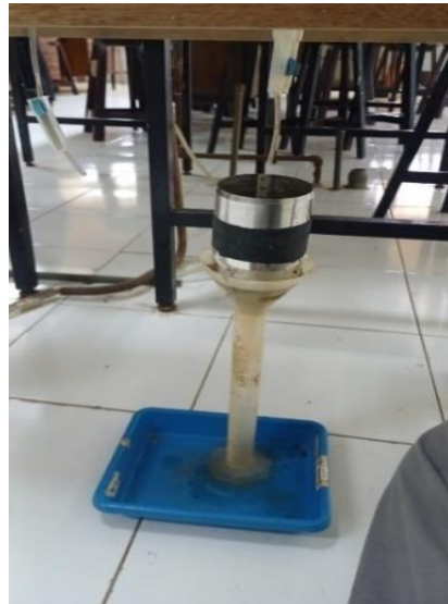
Lampiran Gambar 7 Pengukuran Permeabilitas menggunakan metode Costan Head di Laboratorium Kimia dan Kesuburan Tanah Fakultas Pertanian Universitas Hasanuddin
