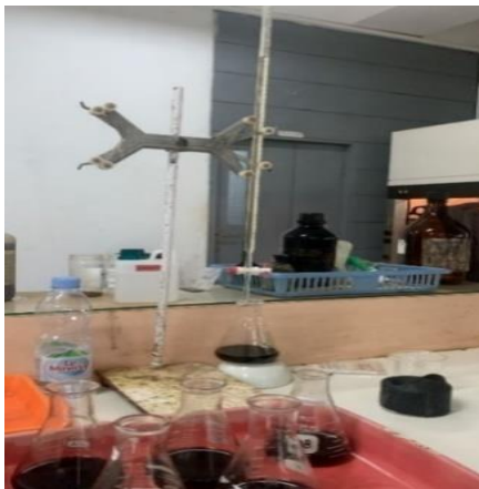
Lampiran Gambar 5. Pengukuran C-organik dengan metode Walkey and Black di Laboratorium Kimia dan Kesuburan Tanah Fakultas Pertanian Universitas Hasanuddin
