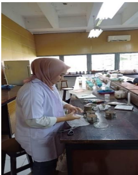
Lampiran Gambar 6. Pengukuran Bulk Density dengan metode Gravimetrik di Laboratorium Kimia dan Kesuburan Tanah Fakultas Pertanian Universitas Hasanuddin
