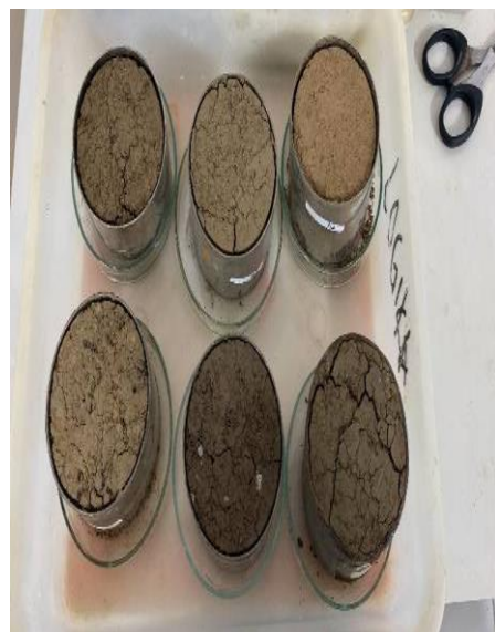
Lampiran Gambar 6. Pengukuran Bulk Density dengan metode Gravimetrik di Laboratorium Kimia dan Kesuburan Tanah Fakultas Pertanian Universitas Hasanuddin
