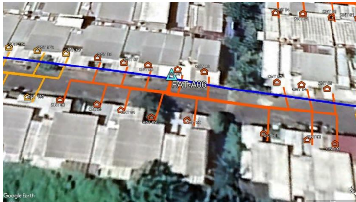
Pemetaan Jalur Kabel Drop Pada FAT 06
