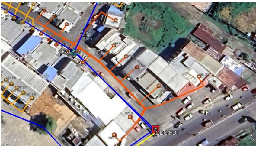
Pemetaan Jalur Kabel Drop Pada FAT 01
