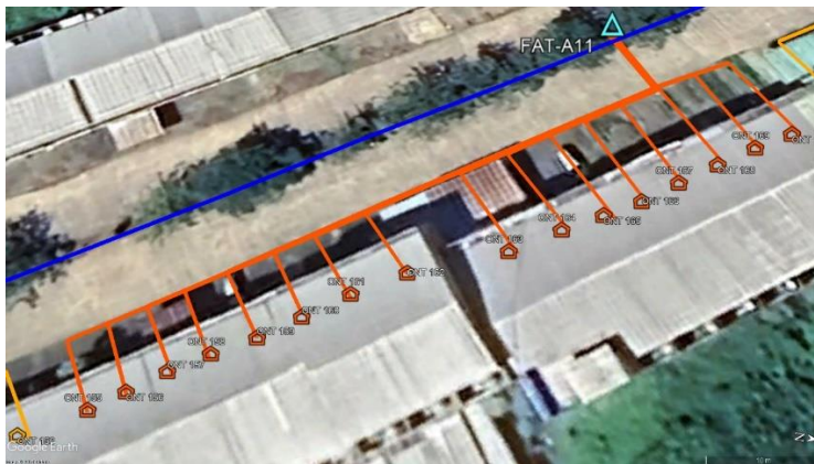
Pemetaan Jalur Kabel Drop Pada FAT 11
