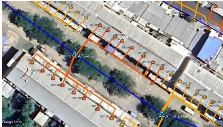
Pemetaan Jalur Kabel Drop Pada FAT 09
