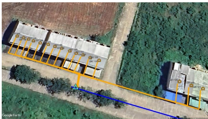
Pemetaan Jalur Kabel Drop Pada FAT 12
