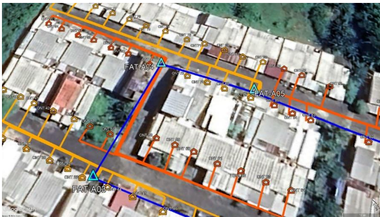
Pemetaan Jalur Kabel Drop Pada FAT 04
