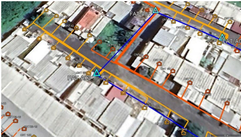
Pemetaan Jalur Kabel Drop Pada FAT 03
