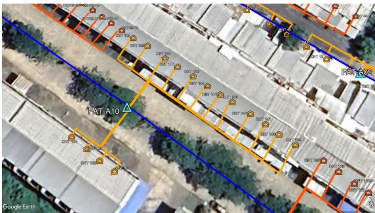
Pemetaan Jalur Kabel Drop Pada FAT 10
