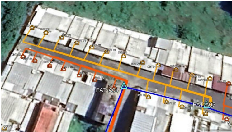
Pemetaan Jalur Kabel Drop Pada FAT 05
