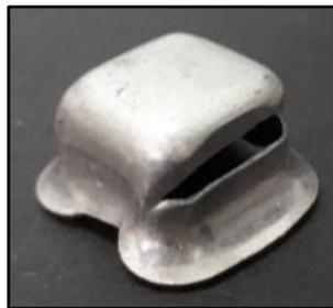
Gambar 7 Cacat *tearing*
