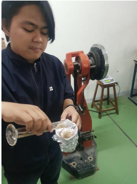
Gambar B. 9 Melakukan Penggabungan Resin, serbuk bambu dan hardener
