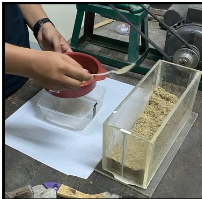
Gambar B. 2 Proses Meshing menggunakan Mesh 60 & 80
