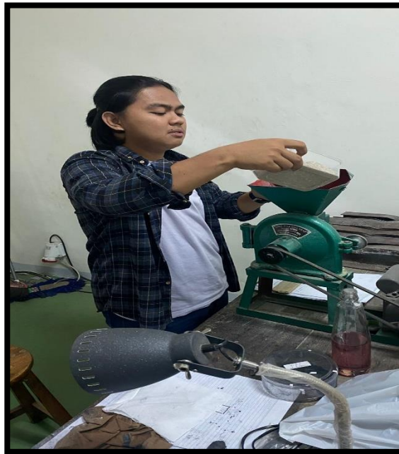
Gambar B. 1 Penggilingan Bambu menggunakan Mesin Disk Mill
