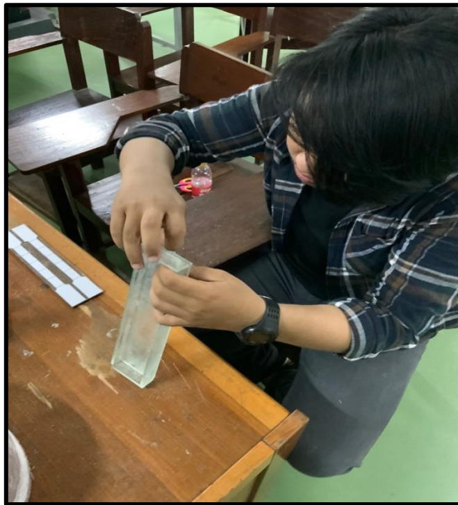
Gambar B. 5 Melakukan Penggabungan cetakan kaca menggunakan lakban
