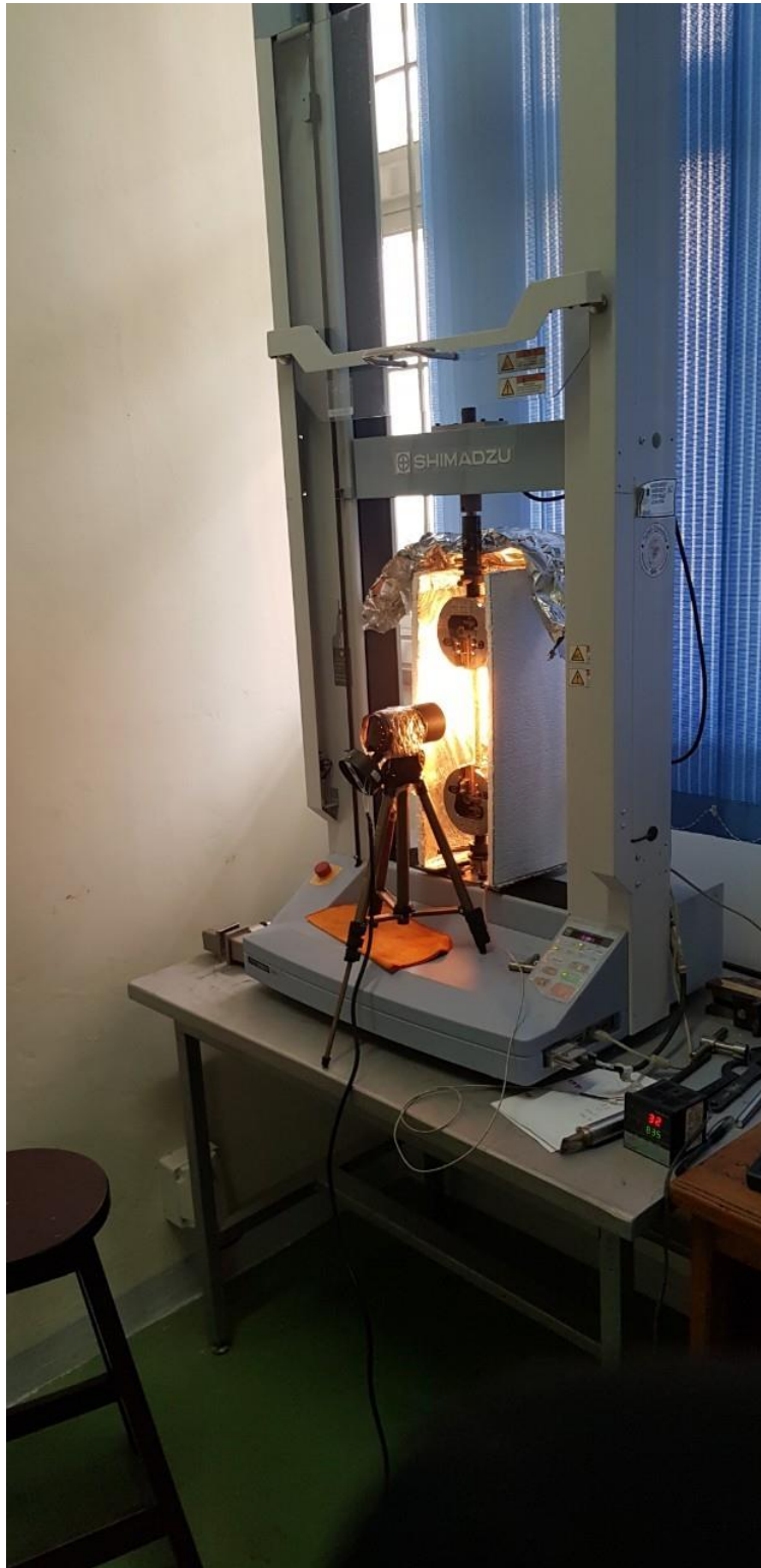
Gambar B. 16 Pengujian Tarik 40°C
