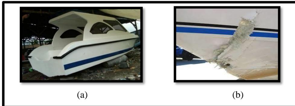
Gambar. 15 (a) Gambar Kapal *Fiber Glass*, (b) Gambar Kerusakan Pada *Fiber Glass*
