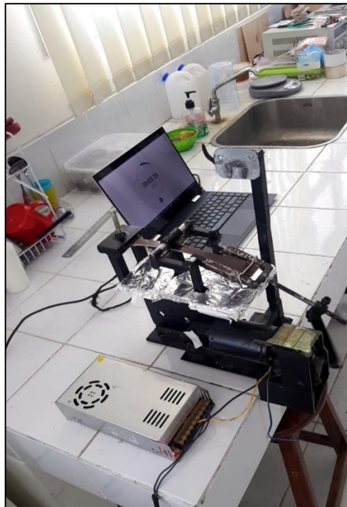
Gambar B. 16 Uji Fatik Temperatur 28°C
