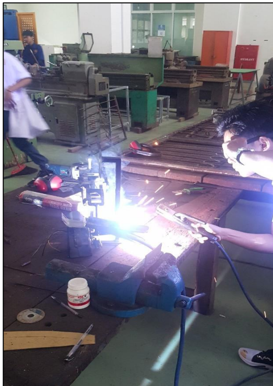
Gambar B. 14 Pengelasan Alat Uji Fatik
