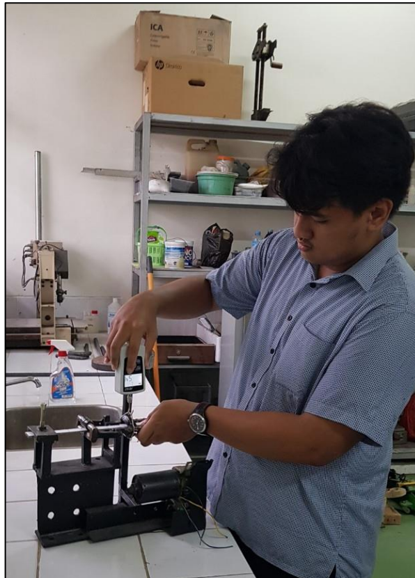
Gambar B. 15 Pengukuran Gaya dan Defleksi pada Alat Uji Fatik
