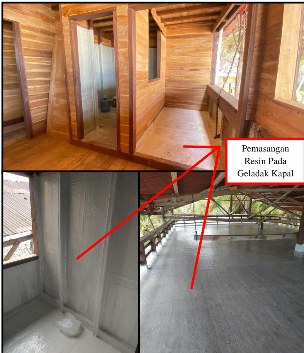
Gambar 9 Contoh Hasil Pemasangan *Glass fiber* pada geladak kapal
