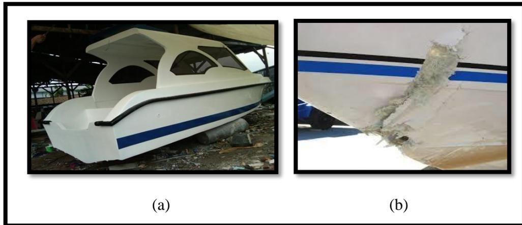
Gambar 7 a) Gambar Kapal *Fiber Glass*, (b) Gambar Kerusakan Pada *Fiber Glass*
