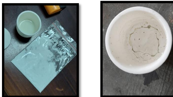
Gambar B.2 Proses kalsinasi bubuk cangkang kerang darah
