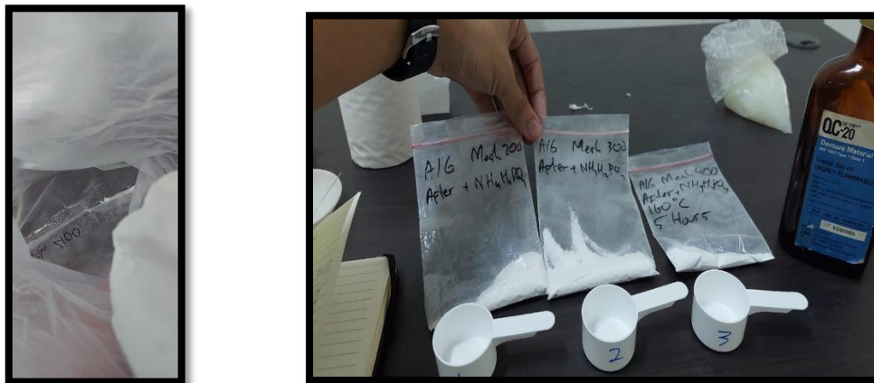
Gambar B.3 Proses silanisasi titanium dioksida
