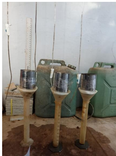
Proses Pengukuran Permeabilitas Tanah Menggunakan Metode Permeameter
