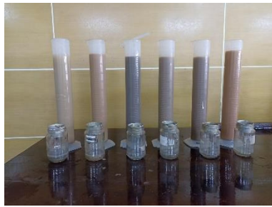
Proses Pengukuran Tekstur Tanah Menggunakan Metode Hidrometer
