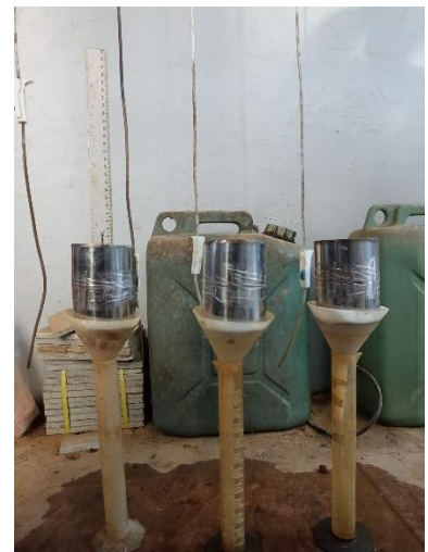
Proses Pengukuran Permeabilitas Tanah Menggunakan Metode Permeameter
