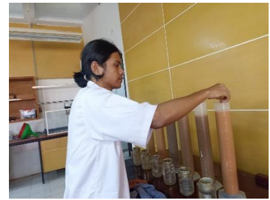
Proses Pengukuran Tekstur Tanah Menggunakan Metode Hidrometer
