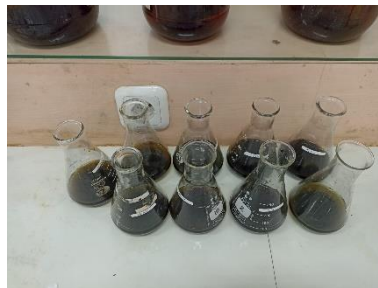
Proses Pengukuran C-Organik Menggunakan Metode Walkley and Black
