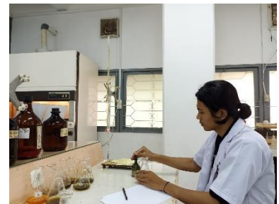
Proses Pengukuran C-Organik Menggunakan Metode Walkley and Black
