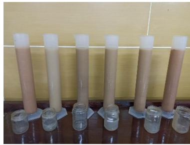
Proses Pengukuran Tekstur Tanah Menggunakan Metode Hidrometer
