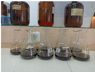
Proses Pengukuran C-Organik Menggunakan Metode Walkley and Black
