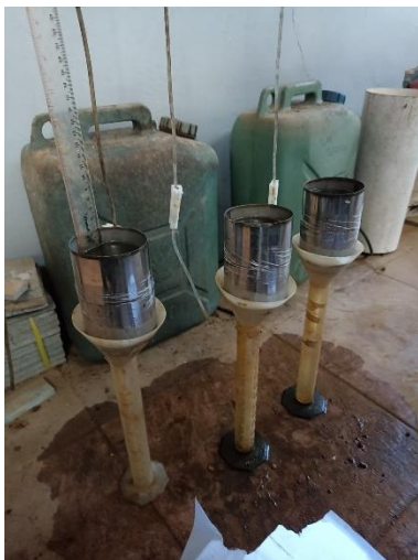
Proses Pengukuran Permeabilitas Tanah Menggunakan Metode Permeameter
