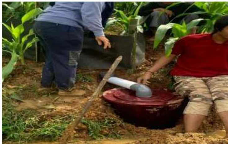
Lampiran 7. Perakitan plot erosi pada pertanaman jagung di Desa Pucak, Kec. Tompobulu, Kab. Maros
