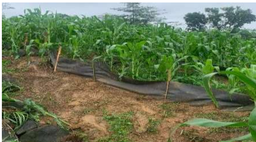
Lampiran 8. Tampak samping plot erosi berukuran (8x2) m pada pertanaman jagung di Desa Pucak, Kec. Tompobulu, Kab. Maros
