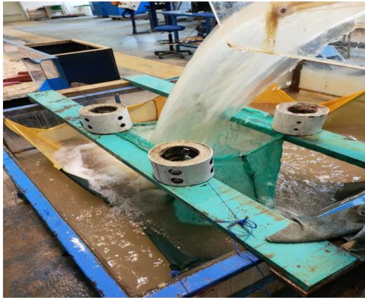
Gambar 37. Tampungan sedimen yang tergerus
