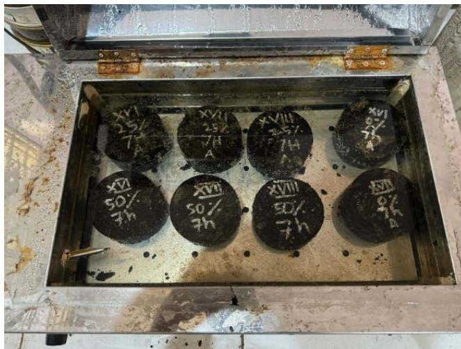
Perendaman menggunakan water bath dengan suhu 60°C sebelum dilakukan pengujian marshall
