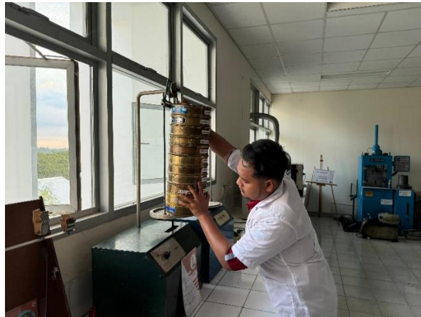
Pengujian analisa saringan agregat menggunakan alat sieve shaker
