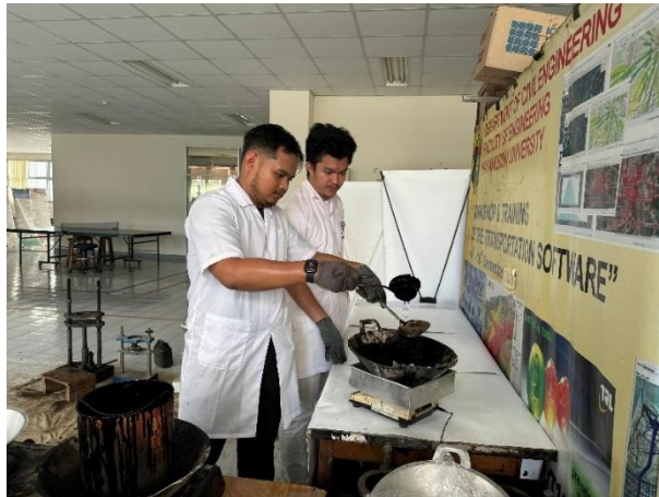
Penimbangan bahan aspal sesuai dengan kadar aspal yang telah ditentukan
