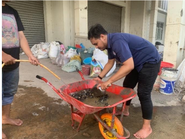
Mencuci sampel agregat untuk benda uji
